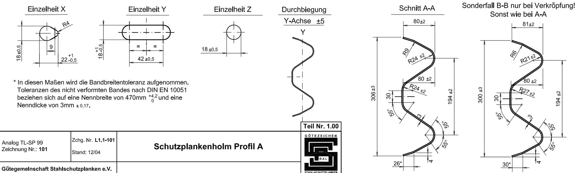
\* In diesen Maßen wird die Bandbreitentoleranz aufgenommen. Toleranzen des nicht verformten Bandes nach DIN EN 10051 beziehen sich auf eine Nennbreite von 470mm <sup>+4,2</sup><sub>0</sub> und eine Nennstärke von 3mm ± 0,17.
